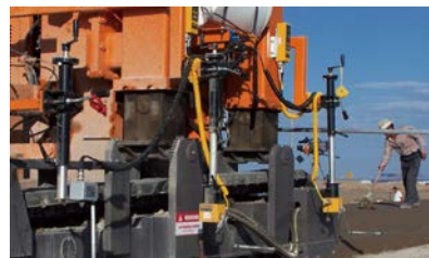
Auto leveling system: Auto leveling and tracing systems ensures paving surface flatness and road straightness. 自动找平系统: 具有自动找平和自动跟踪系统, 确保了路面的平整度和直线性。
